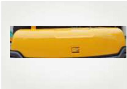
Стальная крышка двигателя толщиной 3мм обеспечивает надежную защиту от внешнего воздействия.
