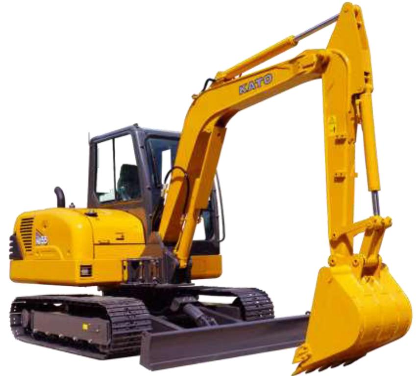
Безопасная кабина, удобная для пользователя, оборудованная предохранительными конструкциями TOPS/ROPS и комфортными сиденьями в авиационном стиле.
