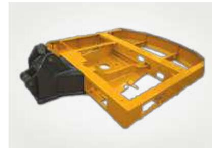
Поворотный край рамы с ударопрочной конструкцией типа D противодействует внешним нагрузкам.
